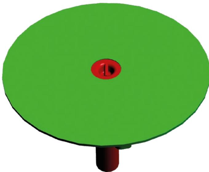
Die Naviplatte wird auf den Schachtkonus aufgelegt und verschließt diesen für den Straßenbau.
