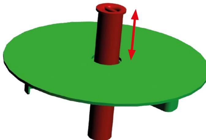
Das Navirohr wird nach dem auftragen der Auffüll- bzw. Asphalt-schichten nach oben gezogen.
